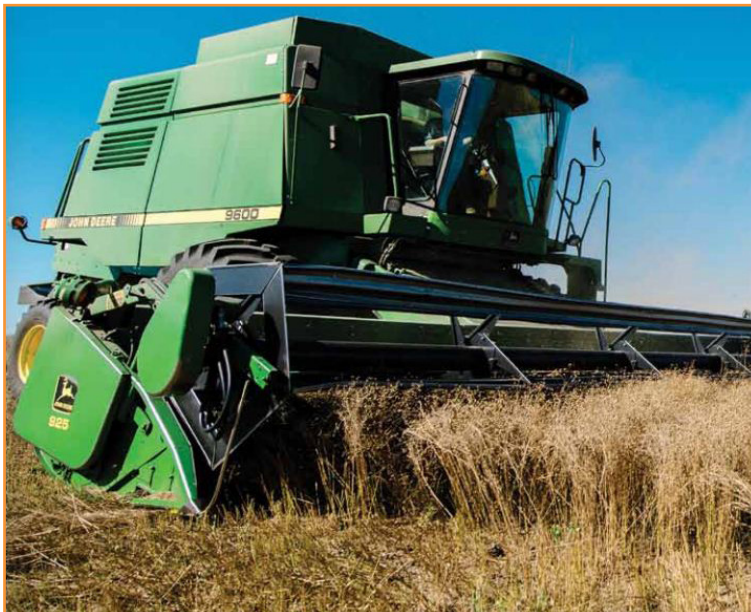
شکل ۴۶- به منظور اجتناب از شکستن دانه در طی برداشت، بایستی کمباین به دقت تنظیم شود
